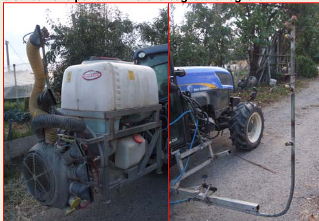
Fig 5: esempio di modifiche apportate al mezzo di distribuzione per ottimizzare la bagnatura fogliare
